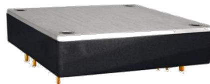
CFDH400-110S48是为铁路领域设计的一款高性能电源, 额定输入电压110Vdc, 输出48V/400W, 无最小负载要求, 宽电压输入66-160Vdc, 稳压单路输出; 高隔离绝缘电压, 允许工作铝基板温度高达100, 具有输入欠压保护, 输出过流保护, 过压保护, 过温保护, 短路保护, 远程遥控及远端补偿, 输出电压调节等功能; 符合EN50155铁路标准, 广泛运用于铁路系统及其关联设备中。
